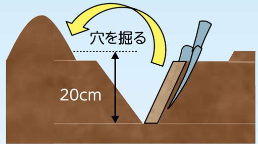
表土を1~2cm(果樹は5cm)取り除き、深さ約20cmのV字型に掘ります。穴の斜面に沿って、一定の厚さを掘り採ります。
